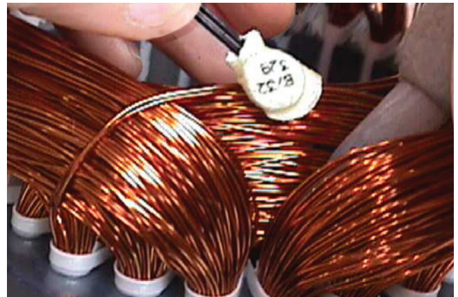
Figura 7.6 - Instalación del protector térmico bimetálico.
