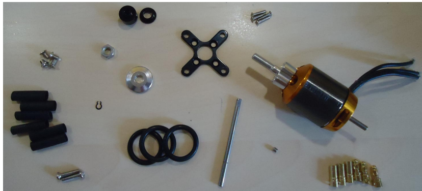
Héctor Ortega. Motor KDA 22-20L i accessoris. 15-11-2012. Imatge disponible a http://www.rcgroups.com/forums/showthread.php?t=1679621&page=9 . / Figura 44. Motor KDA 22-20L i accessoris. D'esquerra a dreta: Tubs termoretràctils, cargols de fixació a la part no rotatòria, clip "c" (utilitzat per a mantenir el shaft en el seu lloc), femella per a l'adaptador collet, prop adapter (peça de plàstic), washer (per a posar sobre l'hèlix al collet), cèrcols de goma (per al prop adapter), muntura tipus X, shaft de recanvi, cargols de recanvi per a fixar el collet al bell, cargol per a fixar el shaft al bell (sense capota), motor KDA amb collet i shaft, connectors bullet 4 mm femella i mascle.
