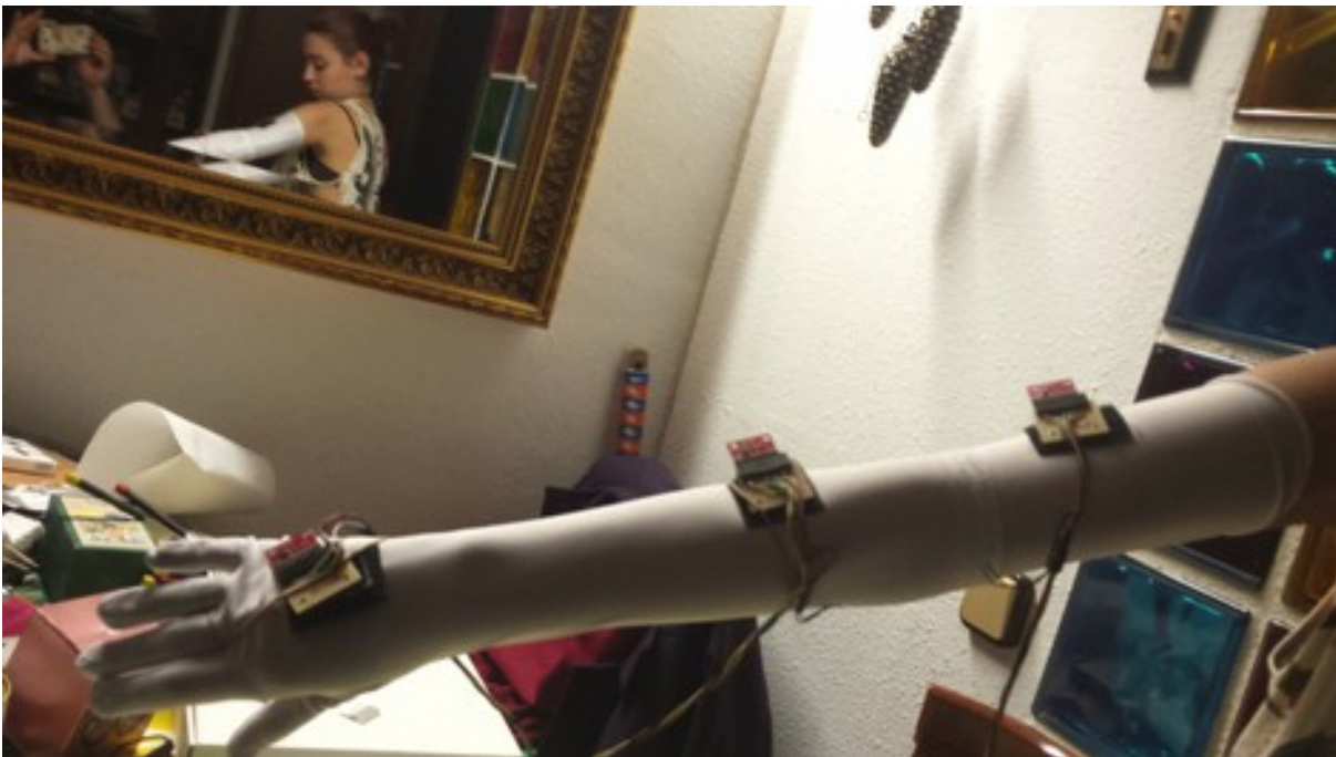
Imatge 46: Posició dels tres acceleròmetres en el guant emissor
