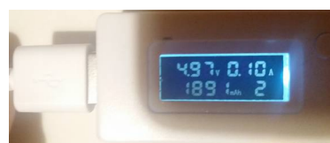
Imatge 33: voltímetre i amperímetre, consum del nostre holter
