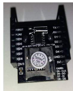
Imatge 24: Data logger shield RTC + MicroSD
