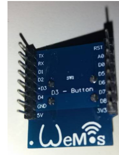
Imatge 26: 1-button shield Wemos cc
