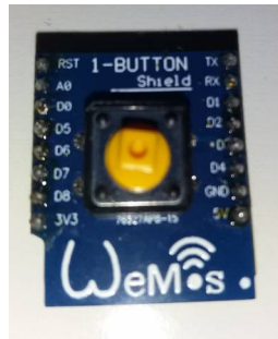
Imatge 25: 1-button shield Wemos cc
